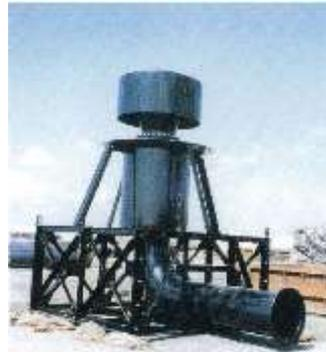
【海水取水管先端架台】
